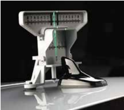
Positionstarget für die Dachantenne
