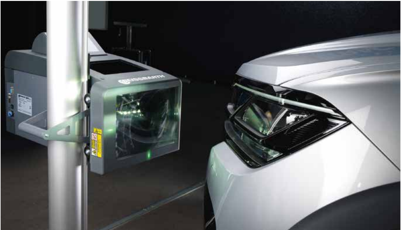
CMOS-Kamera (5 MP) zur digitalen Bildverarbeitung für Messergebnisse mit Live-Bildern in Echtzeit
