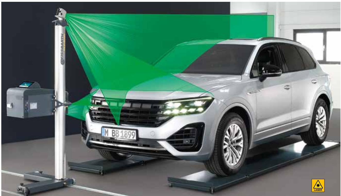
Digitale Scheinwerfereinstellung mit 4 Lasern
